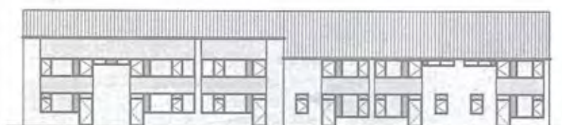
In de kwadranten 2 en 3 zijn antracietkleurige dakpannen gelegd, het stucwerk van de gevelbekleding is in lichtgrijs voor kwadrant 2, en in donkergrijs voor het resterende kwadrant.
